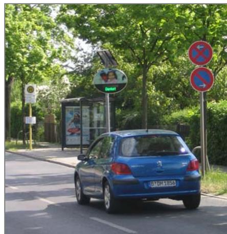
Dialog-Display zur Selbstkontrolle der Kraftfahrer in Abschnitten mit Geschwindigkeitsbeschränkung – hier mit dem Feedback „Danke!“ für das angepasste Fahrverhalten, im anderen Falle wäre in roter Schrift „Langsam!“ zu lesen
