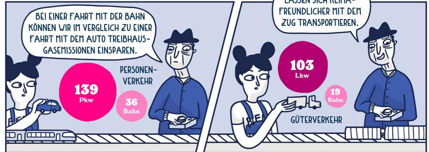
Vergleich des Treibhausgasausstoßes zwischen Straße und Schiene (in Gramm-CO<sub>2</sub>-Äquivalent pro Person- bzw. Tonnenkilometer, 2017)
