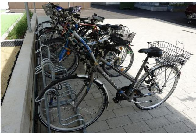
Bild 8: Beim Neubau SEE.STATT auf dem ehemaligen Postareal wurden „Felgenkiller“ aufgestellt. Diese können das Vorderrad beschädigen und ein diebstahlsicheres Anschließen des Fahrradrahmens des Rahmens ist nicht möglich.
