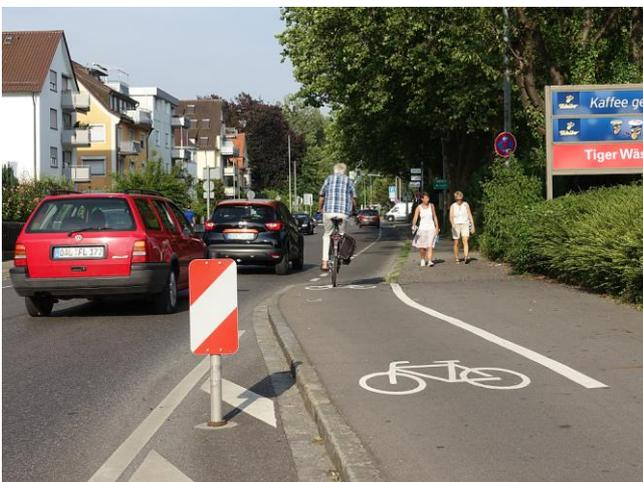
Bild 30: In der Eckenerstraße wurde 1999 der erste Schutzstreifen in Friedrichshafen markiert. Dies ging auf einen Vorschlag des ADFC zurück. Die Akzeptanz des Schutzstreifens durch Radfahrer und auch Kfz ist hoch, da die Restfahrbahnbreite von 5,5 m ausreichend groß ist.
