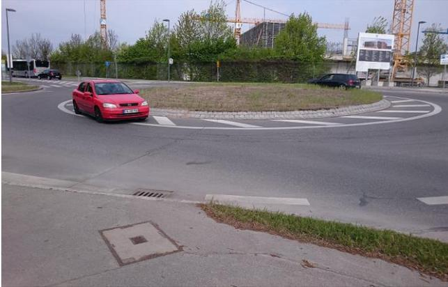
Bild 22: Der Kreisverkehr wurde 2002 als Provisorium eingerichtet und 2008 im Zusammenhang mit der Umgestaltung der Ailinger Straße gebaut. Bei den Radlers Höhen und Tiefen 2008 wurde bereits bemängelt, dass kein erhöhter Innenring eingebaut worden war. Ein erhöhter Innenring wird in gängigen Bauvorschriften aus Verkehrssicherheitsgründen gefordert, da die Geschwindigkeit im Kreisverkehr dadurch reduziert und das Überholen von Radfahrern durch Kfz unterbunden wird.
