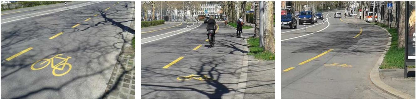
Bild 7a – 7c: Radstreifen mit Überbreite für sichere Überholmanöver (Nordring, Bern – Veloschnellroute Stadtzentrum – Wankdorf) (Quelle: Transitec)
