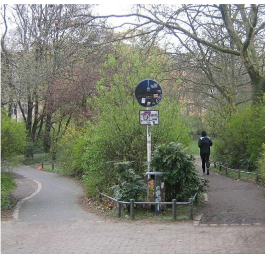
Abb. 12: Getrennte Wege im Böcklerpark in Kreuzberg: Asphalt für Radfahrer und wassergebundene Decke für Fußgänger. Das Schild ist nicht erkennbar und die schmalen Wege sind unübersichtlich.
