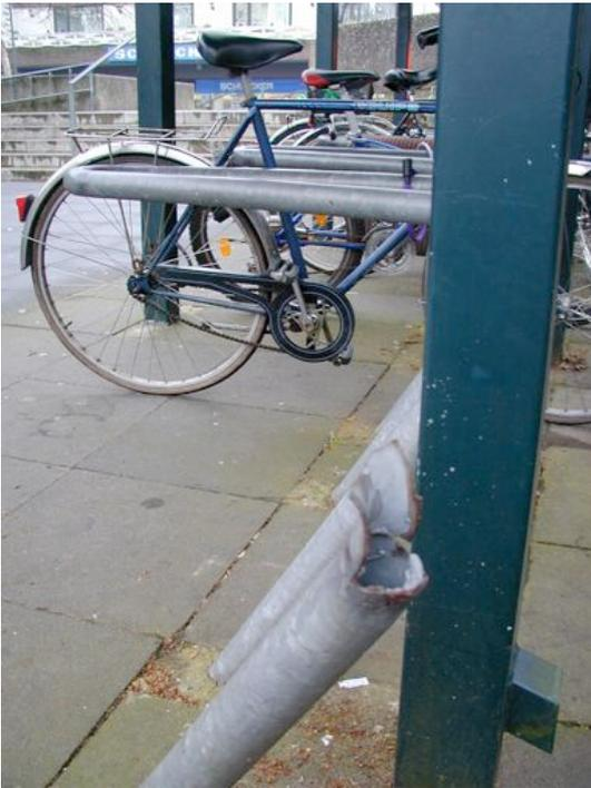
**Abbildung A 2.21: Bruchfläche eines zerstörten Leinebügels**
