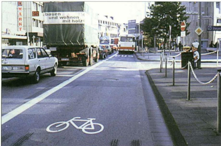
Bild 3: Busfahrstreifen mit zugelassenem Radverkehr (Siegen)
