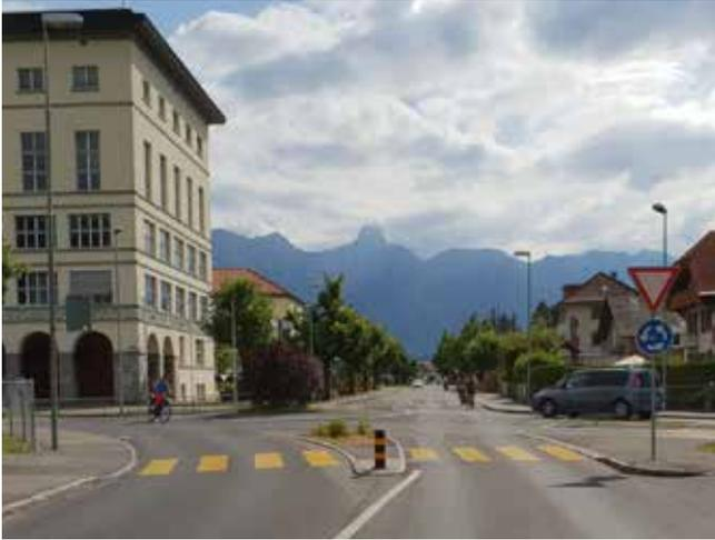
Abb. 1: Kreiselleinfahrt mit fehlender Ablenkung und klarem Durchschuss (Pestalozzistrasse - Jungfraustrasse in Thun, Sanierungsprojekt durch B+S AG in Erarbeitung).
