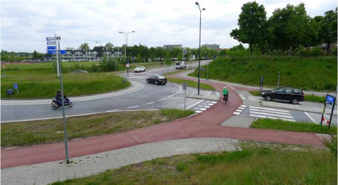
Abb. 6: Kreisel mit separiert geführtem Radweg in Holland. (Foto: D. Sigrist, alle anderen Fotos O. Dreyer)
