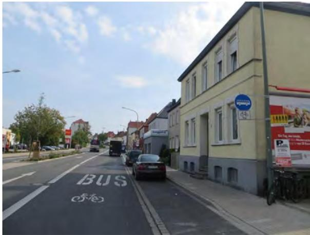
Busspuren, die für Radfahrer freigegeben sind, sind nach FGSV-Arbeitspapier für Radschnellwege nicht zugelassen. Hier muss Radfahrern der Vorrang eingeräumt werden (Radwege mit dem Zusatz „Busse frei“). Die Breite des Radfahrstreifens muss eine Breite von mind. 3 m auf der Strecke und 4,50 m an Haltestellen aufweisen. An LSA ist eine aufeinander abgestimmte Anforderungsmöglichkeit separat für den Rad- und Busverkehr umzusetzen.
