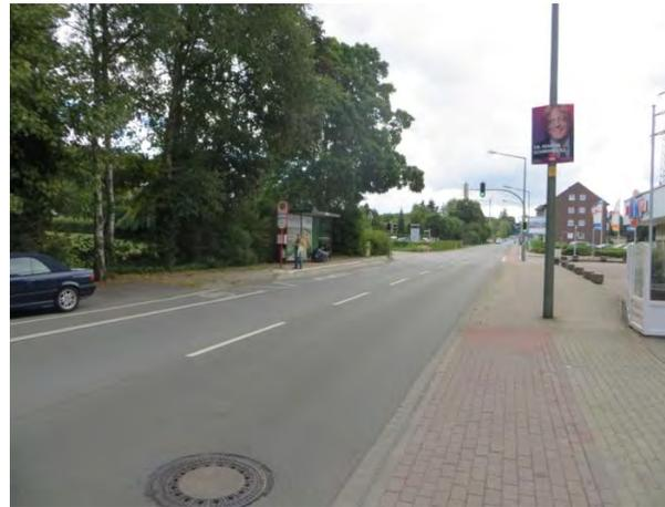
Die Führung des Radschnellweges entlang der Meller Landstraße (K53; 50 km/h) auf einem – getrennt vom Fußverkehr – Hochbordradweg, wie er dort aktuell von Radfahrern benutzt wird, stellt ein Problem dar. Die benötigten Breiten von 3 m für einen Radweg im Einrichtungsverkehr zuzüglich der anzustrebenden 2 m Breite für den Fußverkehr kann im Bestand nur schwer erreicht werden (siehe Kapitel 2.4).
