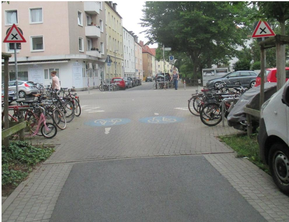
Bild 8: Kreuzung im Zuge einer Fahrradstraße mit Rechts-vor-Links-Regelung und angehobener Kreuzungsfläche (Hannover)
