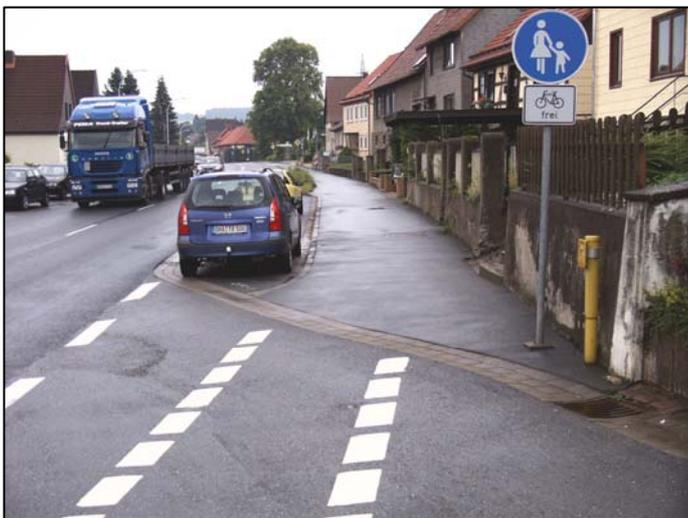
Furtmarkierung im Zuge der Radverkehrsführung auf dem Gehweg
