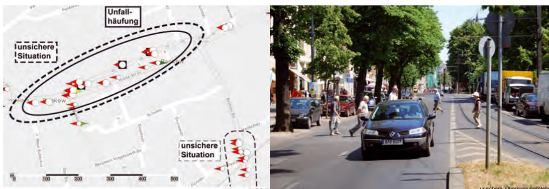
**Bild 15: Unfalltypenkarte (3-Jahres-Karte) und Fotoaufnahme einer Unfallhäufung mit Überschreiten-Unfällen sowie einer von Befragten benannten unsicheren Verkehrssituation**
