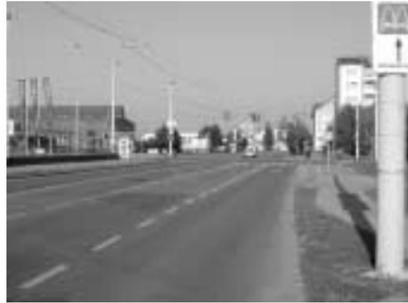
Nach der Kreuzung führt ein kombinierter Gehweg/Radweg weiter, um kurz vor der Hausnr. 60 als eigener Radweg nach links zu schwenken (siehe Foto unten links und rechts). Hier wäre zur Unterstützung der Orientierung eine Bodenmarkierung bzw. Beschilderung angebracht, da hier sicher viele Radfahrer geradeaus fahren.
