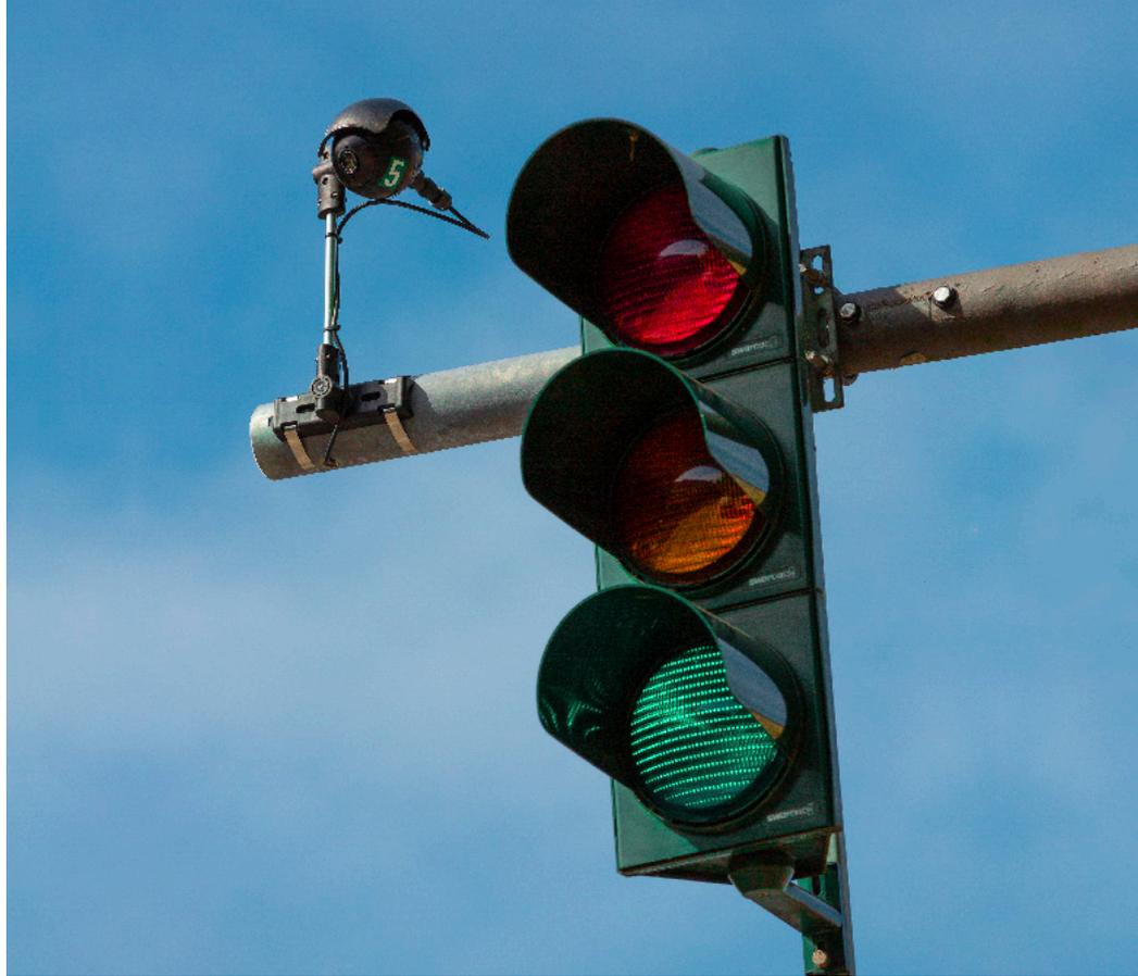
Dank Wärmebildkameras an den Ampeln erfolgt schon bald eine automatisierte Verkehrsmengenerfassung.
