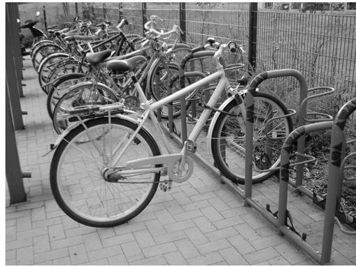
Reifenaufnahme mit Anlehnmöglichkeit für Vorderrad
