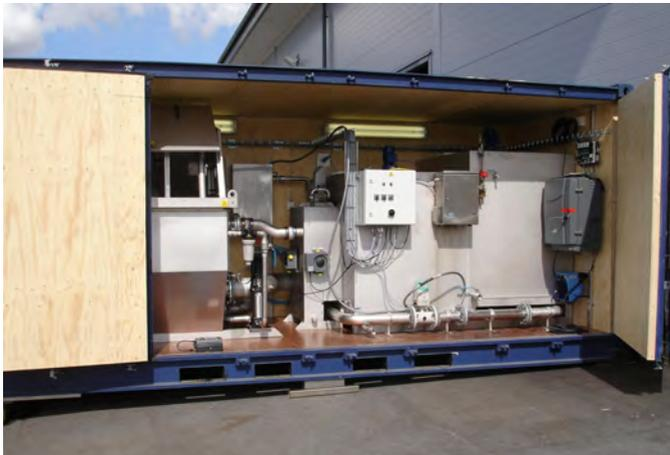
Pilotanlage Scheibenfilter mit Mikrosiebung
