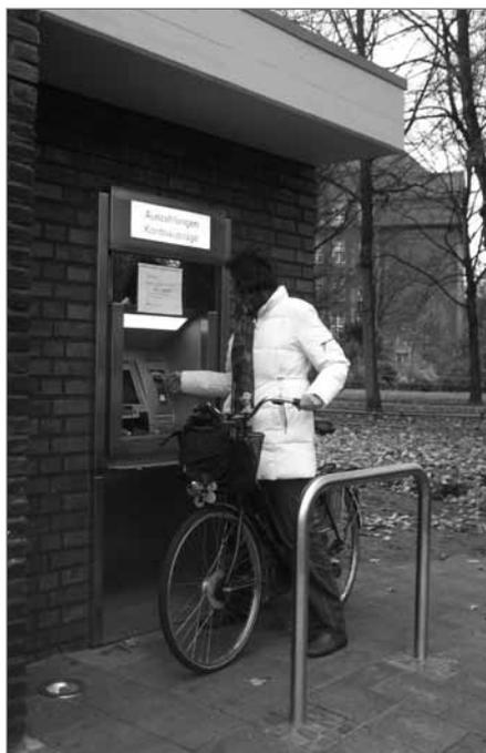
Fahrrad-Schalter mit Haltestange und kleiner Überdachung
