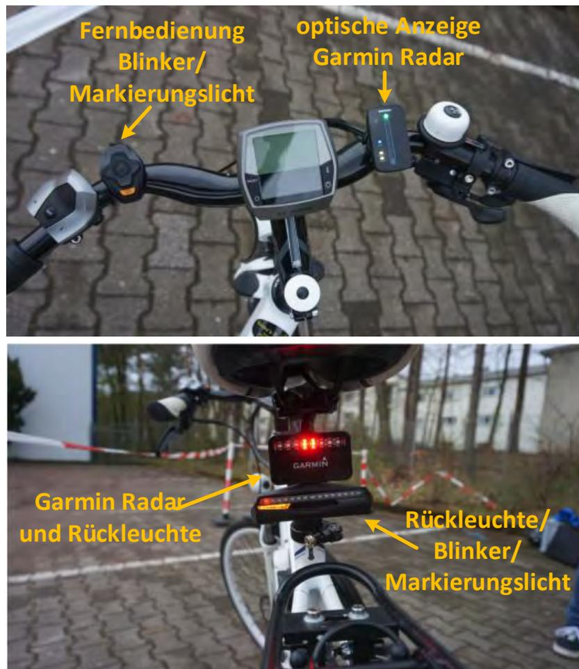
Abbildung 15: Garmin Varia Fahrrad-Radar und LED Rücklicht mit Blinker und Markierungslicht (Quelle: eigene Darstellung)
