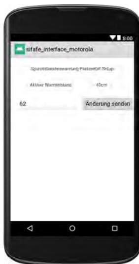
Abbildung 41: Einstelloberfläche Spurverlassenswarnung (Quelle: eigene Darstellung)
