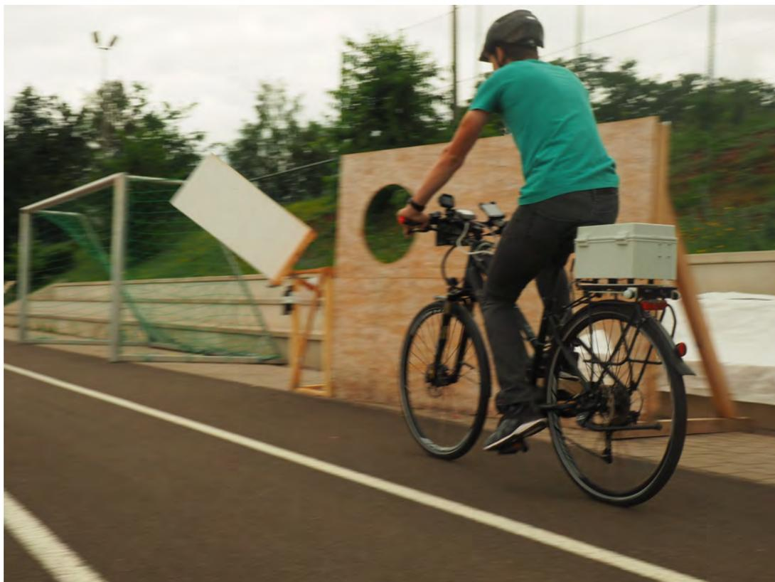
Abbildung 22: Dynamisches Hindernis bei den Testfahrten der Frontalkollisionswarnung (Quelle: eigene Darstellung)
