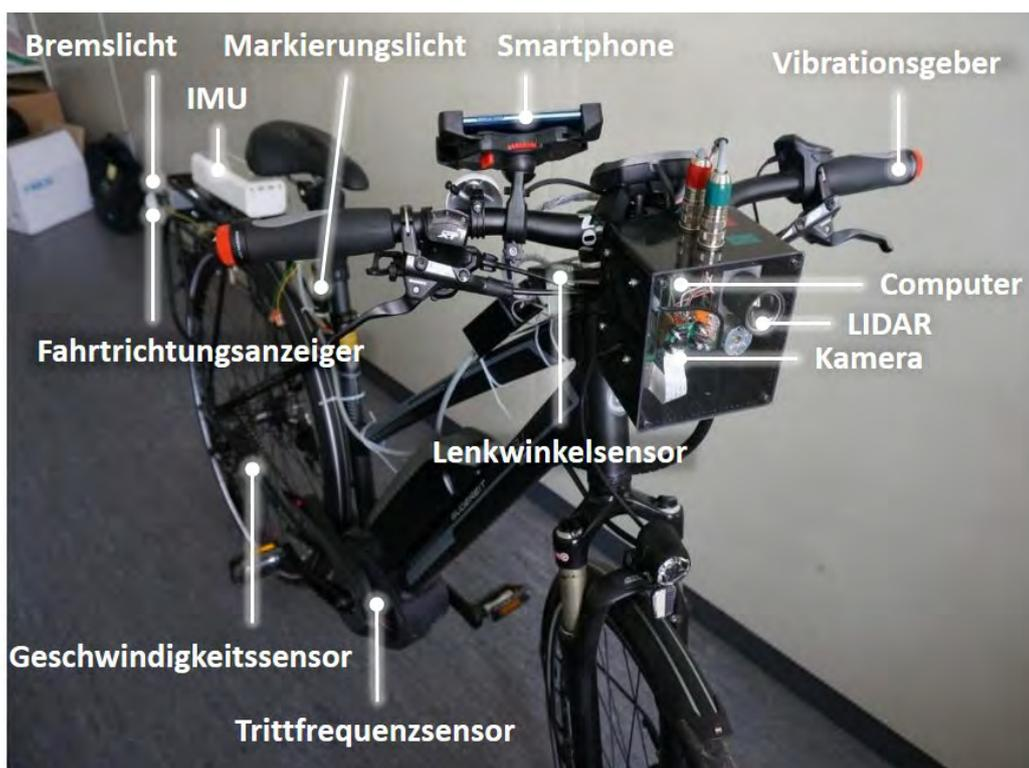
Abbildung 18: Das SIFAFE Versuchspedelec mit diversen Sensoren und Assistenzsystemen (Quelle: eigene Darstellung)
