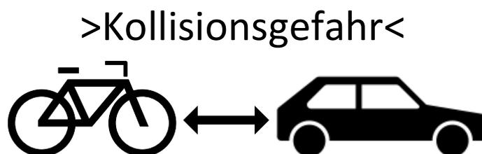
Abbildung 13: Beispiel optische Warnung für Frontkollisionswarnung (Quelle: eigene Darstellung)
