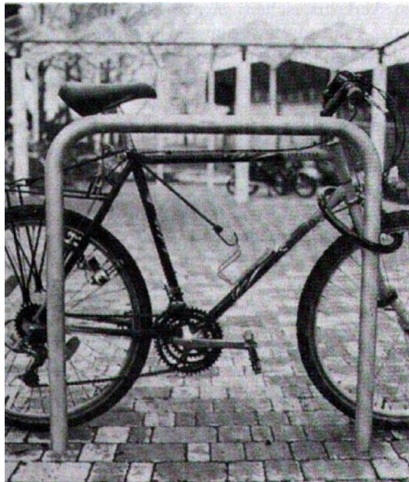
Abb. 4-1: diebstahlsichere Anschlussmöglichkeit von Rahmen und Laufrad (Anlehnbügel)
