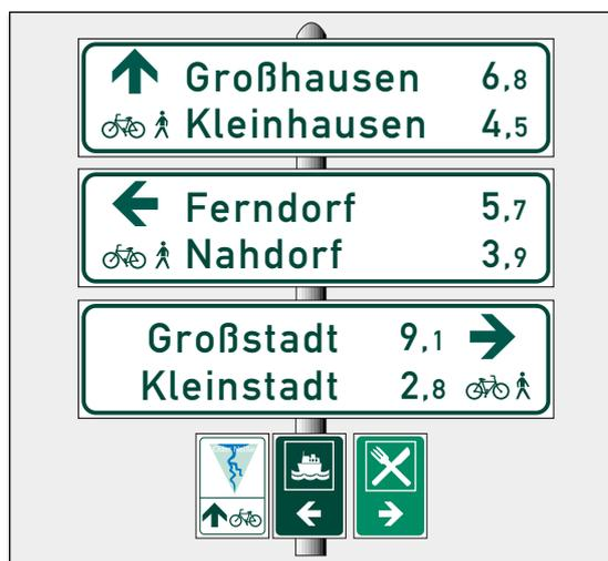
Als Material wird ein Alu-Hohlraumprofil empfohlen, bei welchem die Befestigung von Kurzschildern über eine Einschiebe-Schiene an den Vollschildern erfolgen kann.
