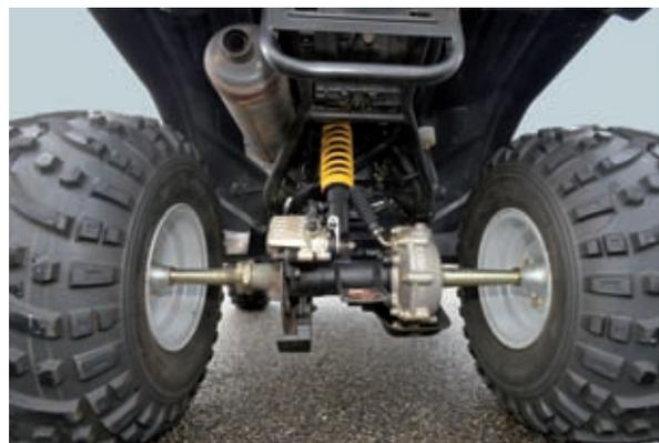
*Hinterachse mit fehlendem Differential*
