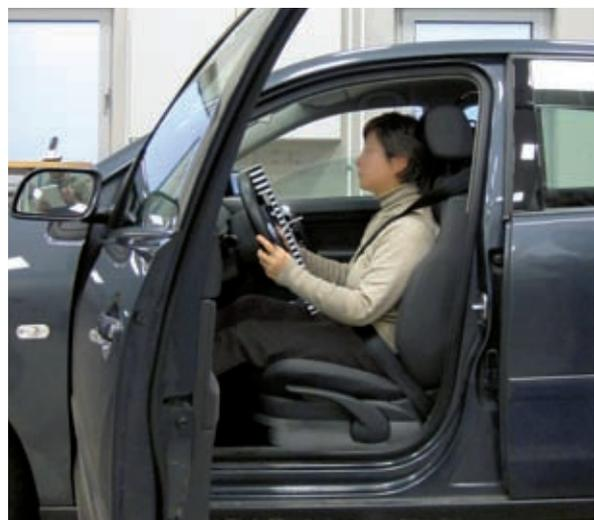
Es zeigte sich, dass moderne Fahrzeuginterieurs, obwohl sie in Europa nur mit dem durchschnittlich großen „männlichen“ Dummy getestet werden, auch kleinen Fahrern einen guten Schutz beim Frontalaufprall bieten. Mit Hilfe „schaltbarer“ Komponenten, die beispielsweise die Airbag-Eigenschaften abhängig von der Entfernung des Fahrers zum Lenkrad verändern, ließe sich das Rückhaltesystem für unterschiedlich große Insassen noch weiter optimieren.
