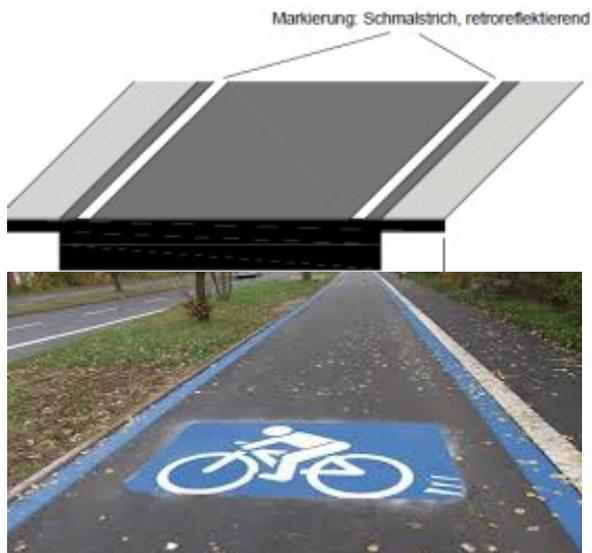
Abbildung 16: Randmarkierung an einem Radschnellweg
