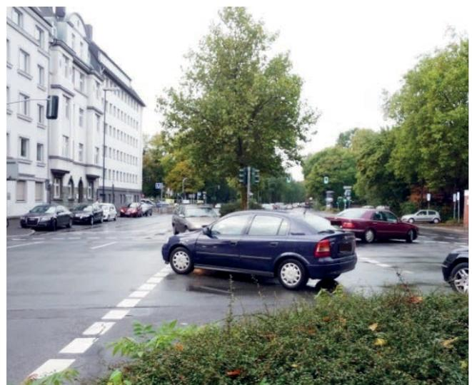
Abbildung 11: Sichtbehinderung für Linksabbieger durch begrünten Mittelstreifen und Fahrzeuge der Gegenrichtung
