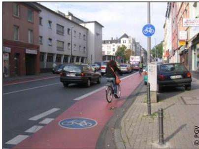
Die Querschnittsgrafik zeigt die Aufteilung des Straßenraumes mit Radfahrstreifen neben dem Bord und neben Längsparkstreifen. Eine Roteinfärbung der Radfahrstreifen wie im Bild ist in der Regel nur in besonderen Gefahrenbereichen erforderlich. Auch muss die Ausbildung des markierten Piktogramms nicht farbig (blau) sein (Kostenaspekte).
