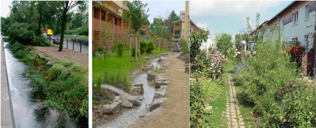
Abb. 65: Referenzbilder Vermeidung von Versiegelung /Entsiegelung: Potsdamer Platz, Berlin (links); Asperg Arkadien, Stuttgart (Mitte); Scharnhäuser Park, Ostfildern (rechts) –weniger Versiegelung in Städten reduziert schädliche Auswirkungen von starken Niederschlägen und einen Hitzeinseleffekt (Ramboll Studio Dreiseitl)
