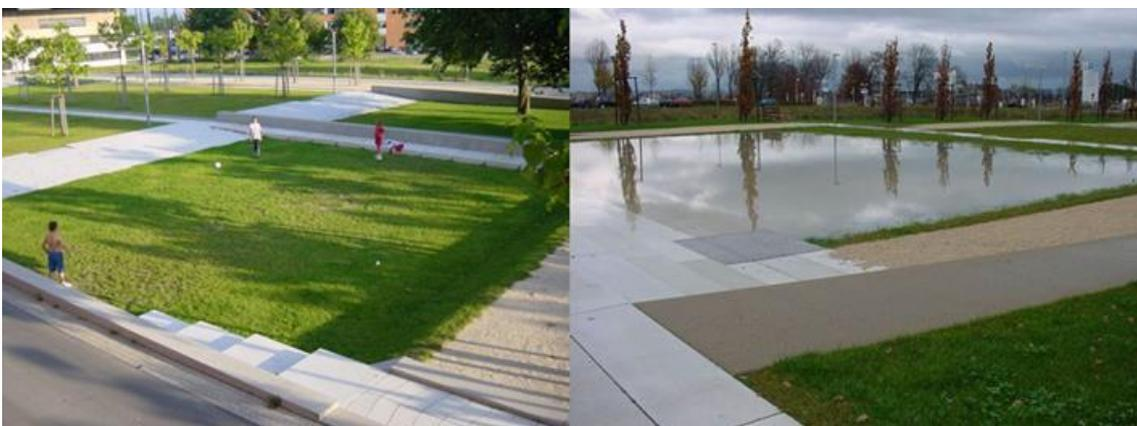
Abb. 69: Referenzbilder Multifunktionale Rückhalteräume: Scharnhauser Park, Ostfildern; der als Grünfläche und Spielwiese angelegte Bereich wird bei Starkregen zu einem oberirdischen Rückhaltelement und Wasserspeicher (Ramboll Studio Dreiseitl)
