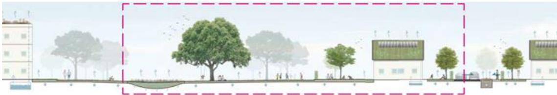
Abb. 33: Schnitt in Nord-Süd-Richtung durch die in Ost-West-Richtung verlaufende Grünfuge zwischen der Einfamilienhaus-Bebauung und den zentralen Mehrfamilienhäusern an der Nord-Süd Grünfläche (Ramboll Studio Dreiseitl)
