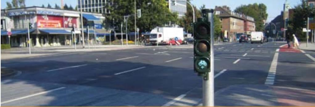
Bei starkem Autoverkehr wird dieser auch durch zusätzliche Ampelsignale vor der Kreuzung angehalten und dem Radfahrer eine sichere Einfahrt in einen Aufstellbereich mit einem Radfahrstreifen neben der Linksabbiegespur ermöglicht. Mit Grünbeginn kann dann der Radfahrer ohne Konflikte mit dem nachfolgenden Autoverkehr nach links abbiegen.
