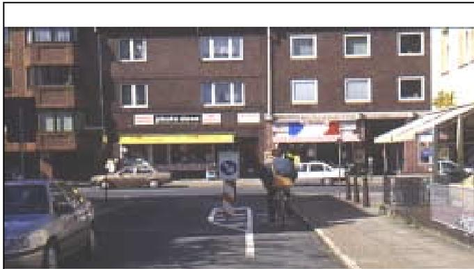
Bild 12: Baulich getrennter Ausfahrtbereich für den gegengerichteten Radverkehr am Übergang zu einer bevorrechtigten Straße (Bremen)
