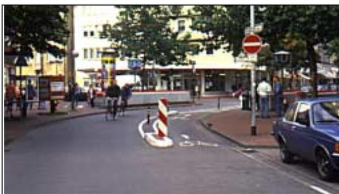
Bild 10: Bauliche Absicherung für gegengerichteten Radverkehr im Kurvenbereich (Hannover)
