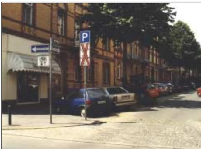
Bild 13: Möglicherweise missverständliche Kombination der Beschilderung an einem Knotenpunkt. Die Pfeile des Zusatzzeichens weisen in die kreuzende, nicht geöffnete Einbahnstraße.
