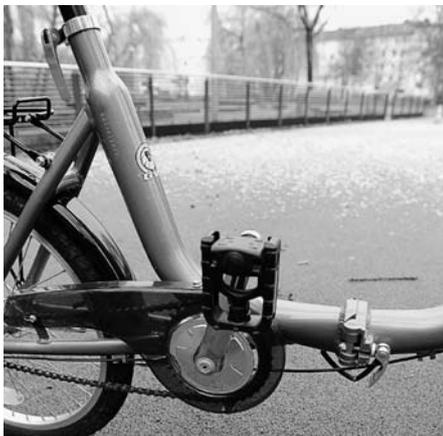
Das Rad mit Klapppedal und verstellbarer Sattelstütze mit Schnellspanner
