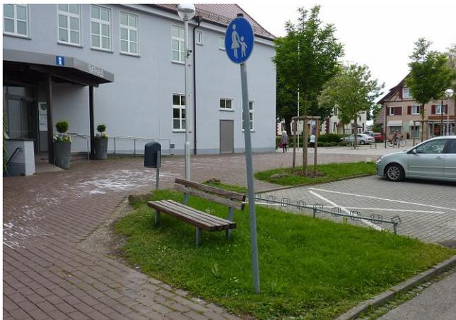
Bild 54: Am Eingang des Rathauses sind verbogene und somit unbenutzbare Felgenklemmer vorhanden. Es fehlt eine Überdachung. Hinzu kommt, dass die Zufahrt zum Rathausplatz für Radfahrer verboten ist (Zeichen 239 StVO „Fußgänger“).
