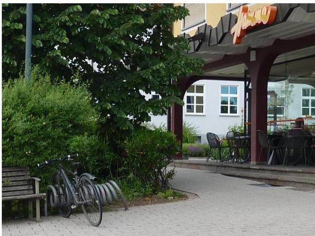
Bild 58: Das abgebildete Beispiel zeigt das zum Abstellen von Fahrrädern völlig untaugliche und bereits beschädigte Modell „Spiralo“.
