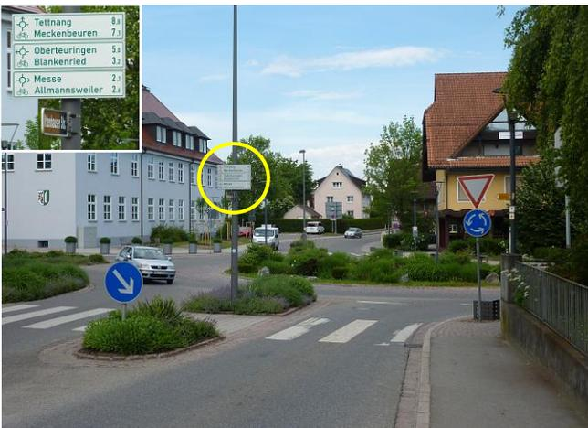
Bild 11: Bei der Einfahrt von der Ittenhauser Straße in den Kreisverkehr sind alle Fahrtrichtungen in einem Tabellenwegweiser mit kleinen Kreisverkehrssymbolen beschildert. Diese Beschilderung kann von Radfahrern bei der Einfahrt in den Kreisverkehr nur schwer erkannt werden.
