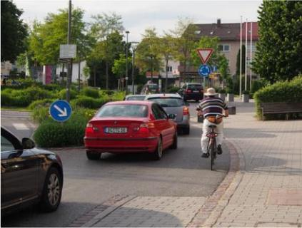
Bild 48: Bei der Zufahrt aus der Bodenseestraße ist eine Ausleitung vom Radweg auf die Fahrbahn vorhanden. Die Verflechtungsstrecke für das „Reißverschlussverfahren“ ist allerdings zu kurz. Auch wegen der leichten Steigung werden Radfahrer von Pkw häufig in der Zufahrt überholt.
