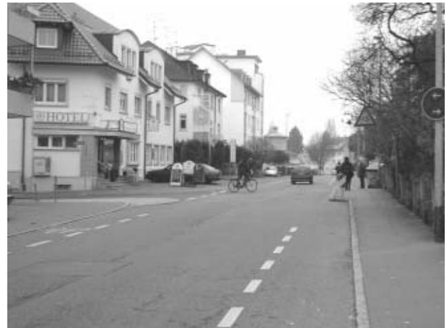
**Nachher:** Im Einmündungsbereich der Hofenerstraße wurde die Fahrbahn baulich verschmälert, die Schutzstreifen engen die Fahrbahn zusätzlich ein. Die Seitenbereiche werden besser wahrgenommen.
