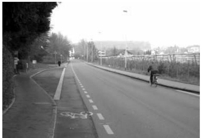
**Bushaltestelle:** Auf der geraden Strecke hilft der Schutzstreifen, die Fahrbahn optisch zu verschmälern.
