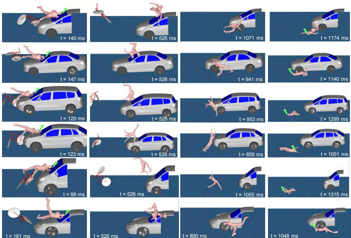
Abb. 3-32: Kinematik bei  $v_{\text{Fzg.}} = 40 \text{ km/h}$  & Pedalstellung fzgs. Bein hinten
