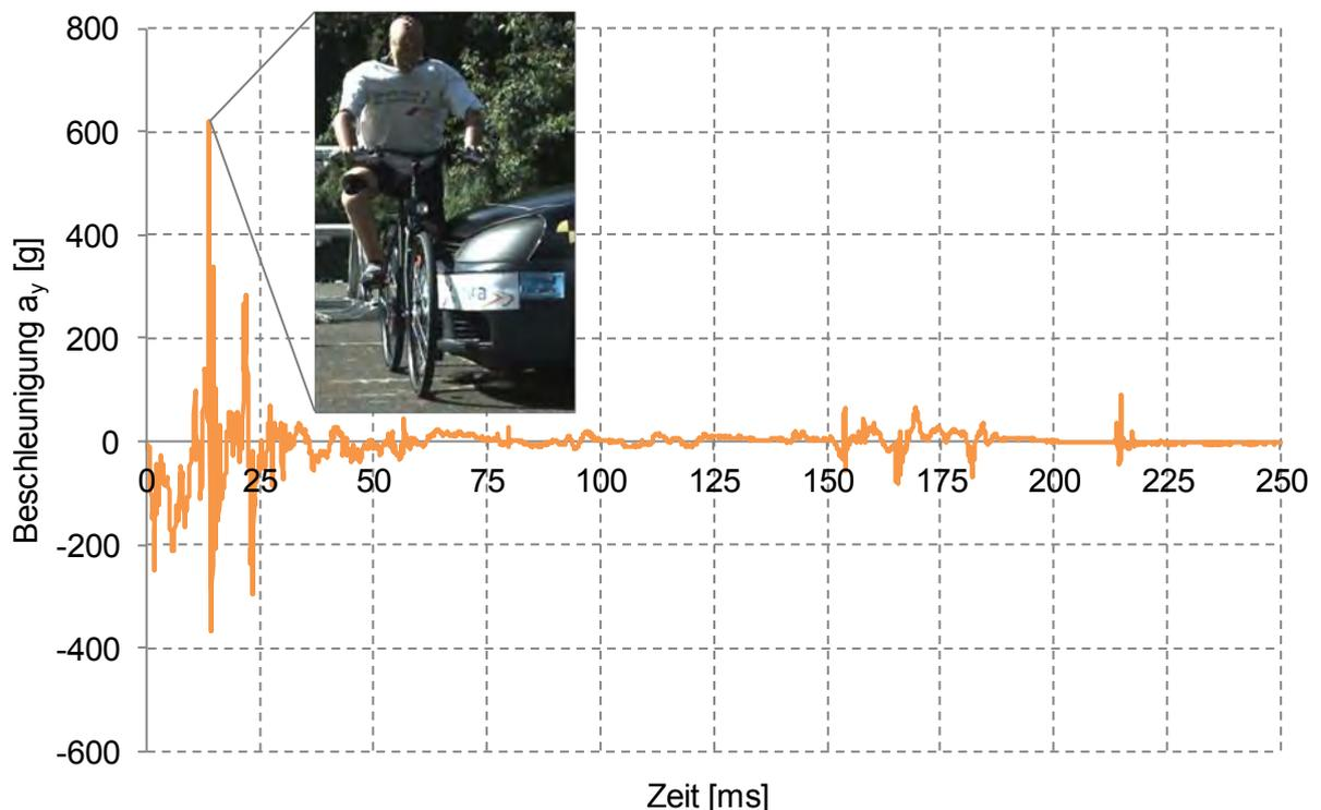
Abb. 5-13: Beschleunigung  $a_y$  des fahrzeugseitigen Knies/Schienbeins (Knee/Tibia)
