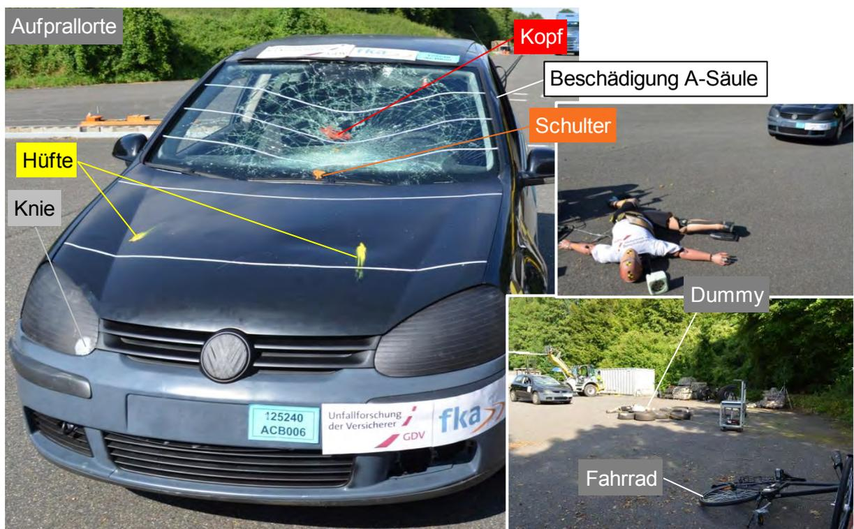
Abb. 5-11: Beschädigungen & Unfallspuren bei  $v_{Fzg} = 39,9$  km/h ( $v_{Radfahrer} = 14,1$  km/h)
