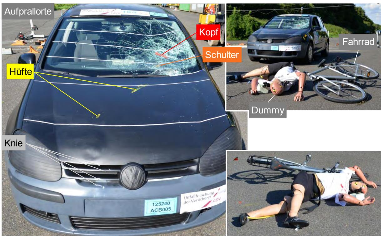
Abb. 5-18: Beschädigungen & Unfallspuren bei  $v_{Fzg} = 29$  km/h ( $v_{Radfahrer} = 13,5$  km/h)
