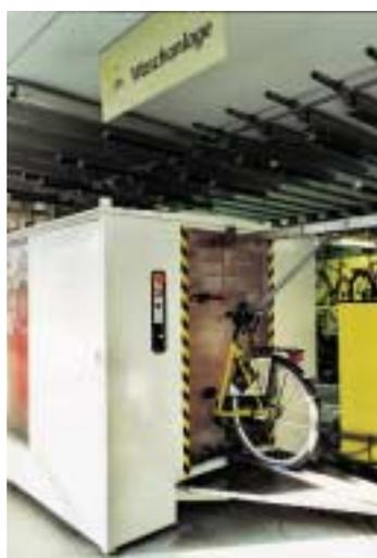
Foto 16: Automatische Fahrradwaschanlage
