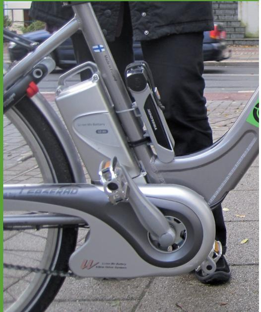
Pedelect mit Mittelmotor. Gut zu sehen der Li-Ion Akku hinter dem Sattelrohr. Foto: BUND
