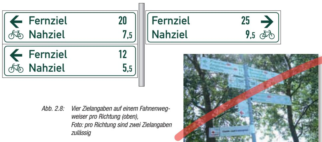
Abb. 2.8: Vier Zielangaben auf einem Fahnenwegweiser pro Richtung (oben),
