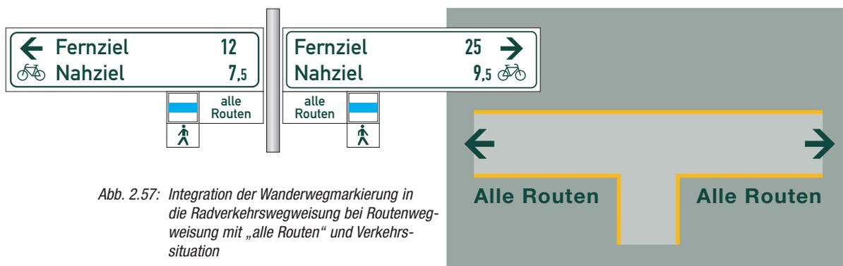
Abb. 2.57: Integration der Wanderwegmarkierung in die Radverkehrswegweisung bei Routenwegweisung mit „alle Routen“ und Verkehrssituation
