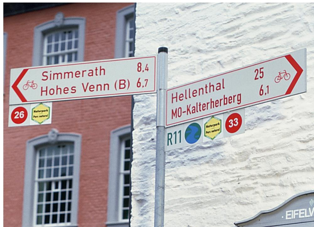
Abb. 3-1: Kombination von ziel- und routenorientierter Wegweisung
