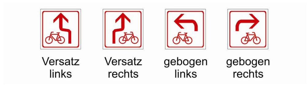
Abb. 3-12: Gestaltungsformen von Zwischenwegweisern als Vorwegweiser (Standort vor der Einmündung)
