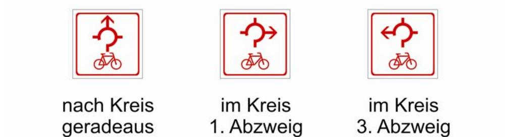
Abb. 3-13: Sonderform der Gestaltung eines Zwischenwegweisers in NRW als Vorwegweiser (Standort vor der Zufahrt in den Kreisverkehr)
