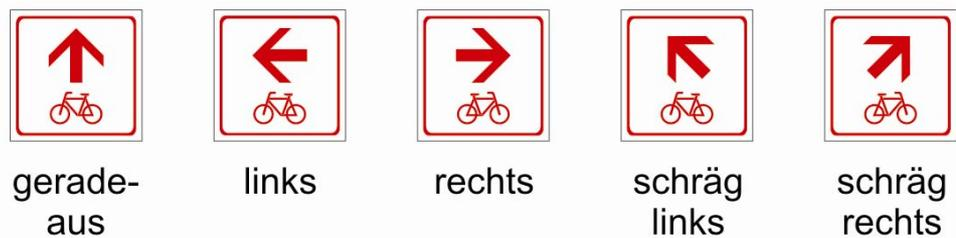
Abb. 3-11: Gestaltungsformen von Zwischenwegweisern zur Routenbestätigung (Standort hinter der Einmündung, vgl. Kap. 3.3.3)
