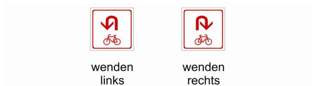
Abb. 3-14: Sonderform der Gestaltung eines Zwischenwegweisers in NRW als Vorwegweiser (Standort vor dem Wechsel der Straßenseite o.ä.)
