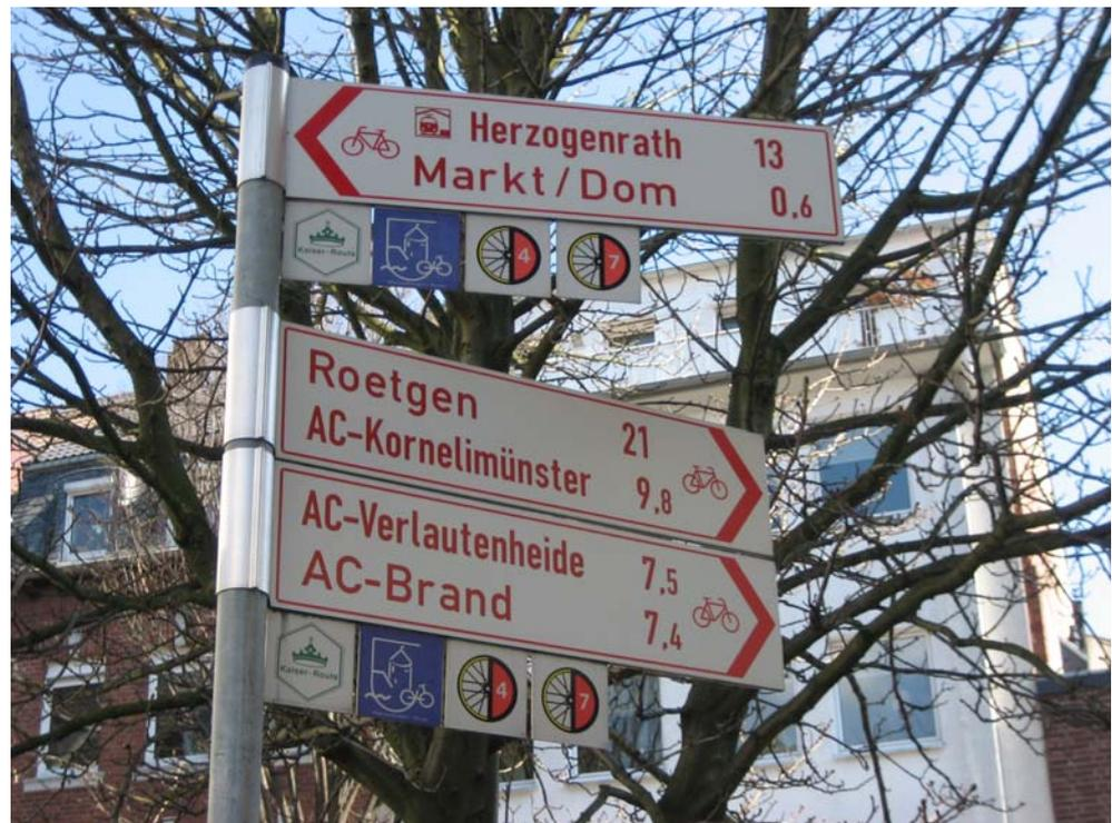
Abb. 3-32: An der Spitze montierter Pfeilwegweiser bei besonders beengten räumlichen Verhältnissen
