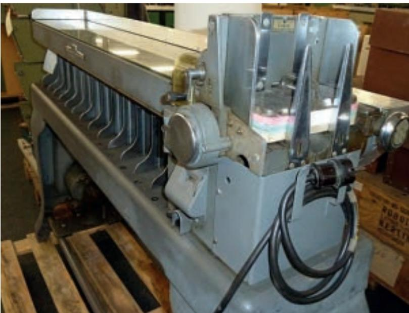
Abbildung 72: Lochkartensortiermaschine
