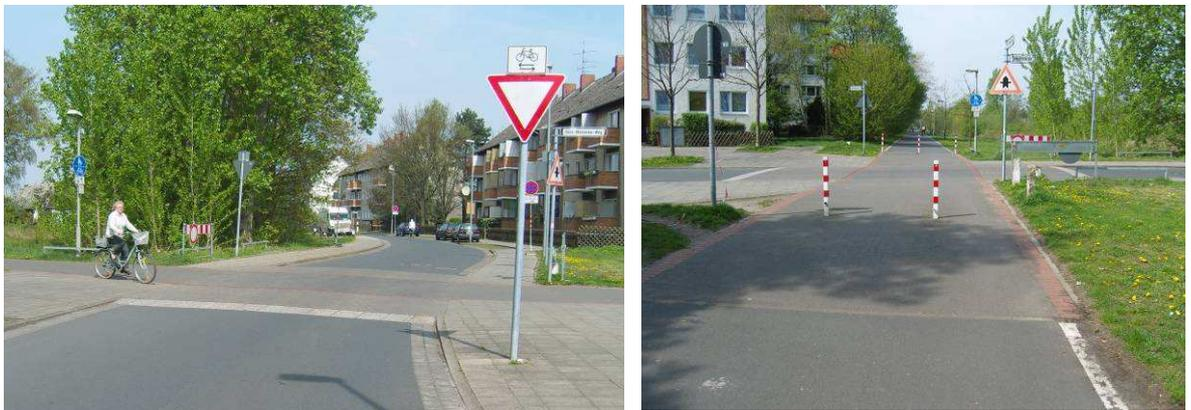
Abb. 42 Bevorrechtigte Querungen für den Radverkehr: Hannover
