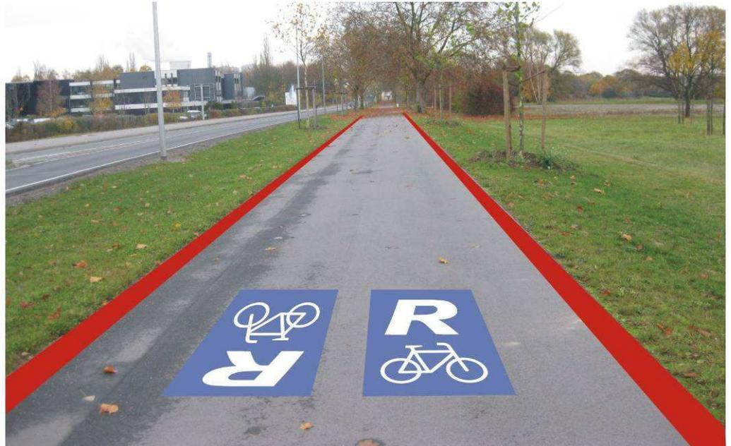
Abb. 13 Beispiel für die Markierung eines Radschnellwegs auf der Strecke
