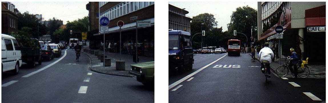
Abb. 28 Radfahrstreifen mit Freigabe für Busse (links) und Bussonderstreifen mit Freigabe für Radfahrer (rechts): Münster
