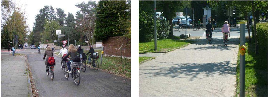
Abb. 43 Signalisierte Querungsstellen mit ca. 30 m vorgelagerter Grünzeitanforderung für Radfahrer: Buchholz i.N. (links), Lemgo (rechts)
