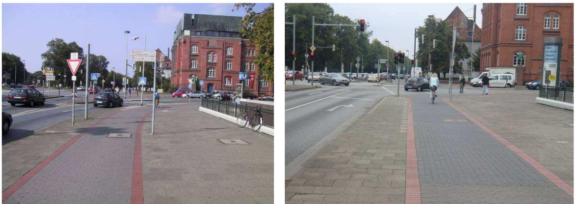
Abb. 41 Vorher Freie Rechtsabbiegefahrbahn, nachher Rechtsabbiegestreifen signalisiert: Hannover
