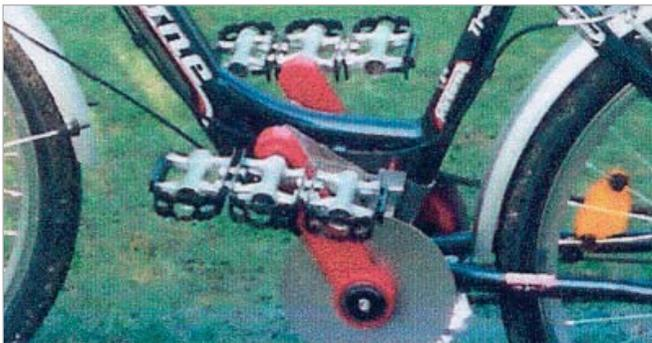
Die Fahrweise auf dem Uni Bike erfolgt entweder sitzend auf dem Sattel oder stehend auf Tretplatten. Die Anwendung des Uni Bike in stehender Fahrweise entspricht einer „Laufmaschine“, die weitestgehend dem Walken nahe kommt und einer Weiterentwicklung.
