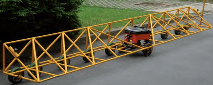
Längsebenheitsmessung mit Planograph
