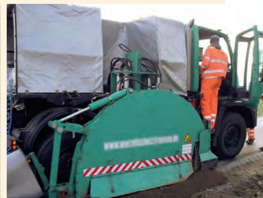
Wurzelschutzfräse zum Einbau einer Wurzelschutzfolie
