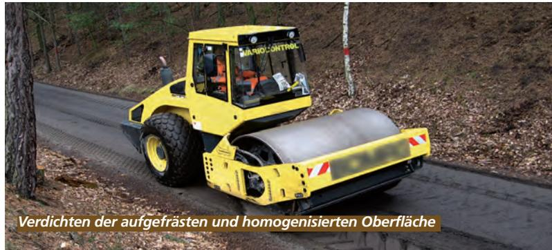
Verdichten der aufgefrästen und homogenisierten Oberfläche
