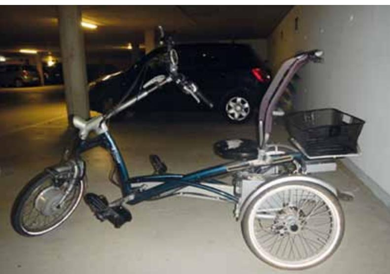
Bild 9: Erwachsenen-Dreirad mit elektromotorischer Unterstützung
