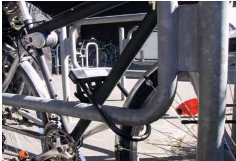
Bild 4: Beispiel eines Anlehnbügels mit Unterholm (Bild: Landeshauptstadt Kiel)
