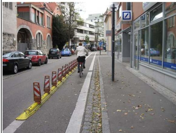
Aufgedübelte Sperreinrichtungen zur Unterbindung des Kfz-Parkens vor einer Bankfiliale im Zuge eines Radfahrstreifens (mit allerdings an dieser Stelle schmaler nutzbarer Breite)
