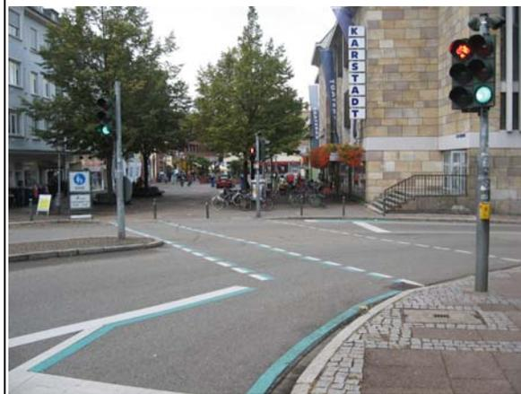
Lösung für abbiegende Radfahrer: Signalisierte Querung zur Fußgängerzone
