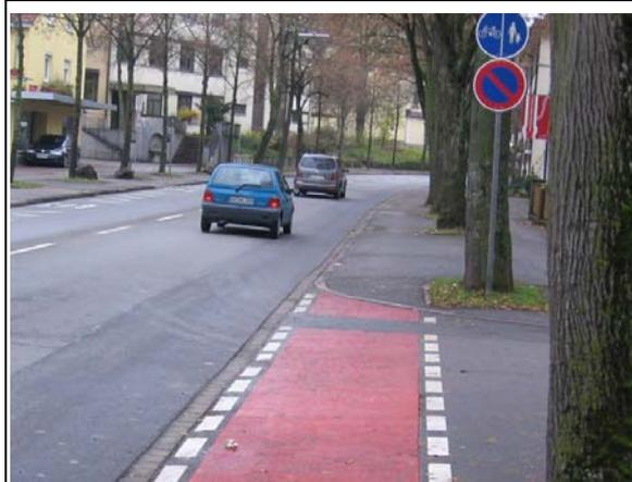
Zu geringe Breite der Radverkehrsanlage, fehlender Sicherheitstrennstreifen
