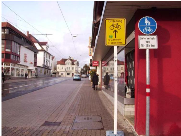
**Abb. 5-21:** Konsequente Ausweisung von Umleitungsstrecken für den Radverkehr an Baustellen in Stuttgart
