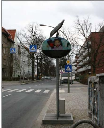
Dialog-Display als Instrument zur Selbstkontrolle für die Fahrzeugführer: „Langsam“ bei zu hoher Geschwindigkeit oder „Danke“ bei angepasstem Fahren
