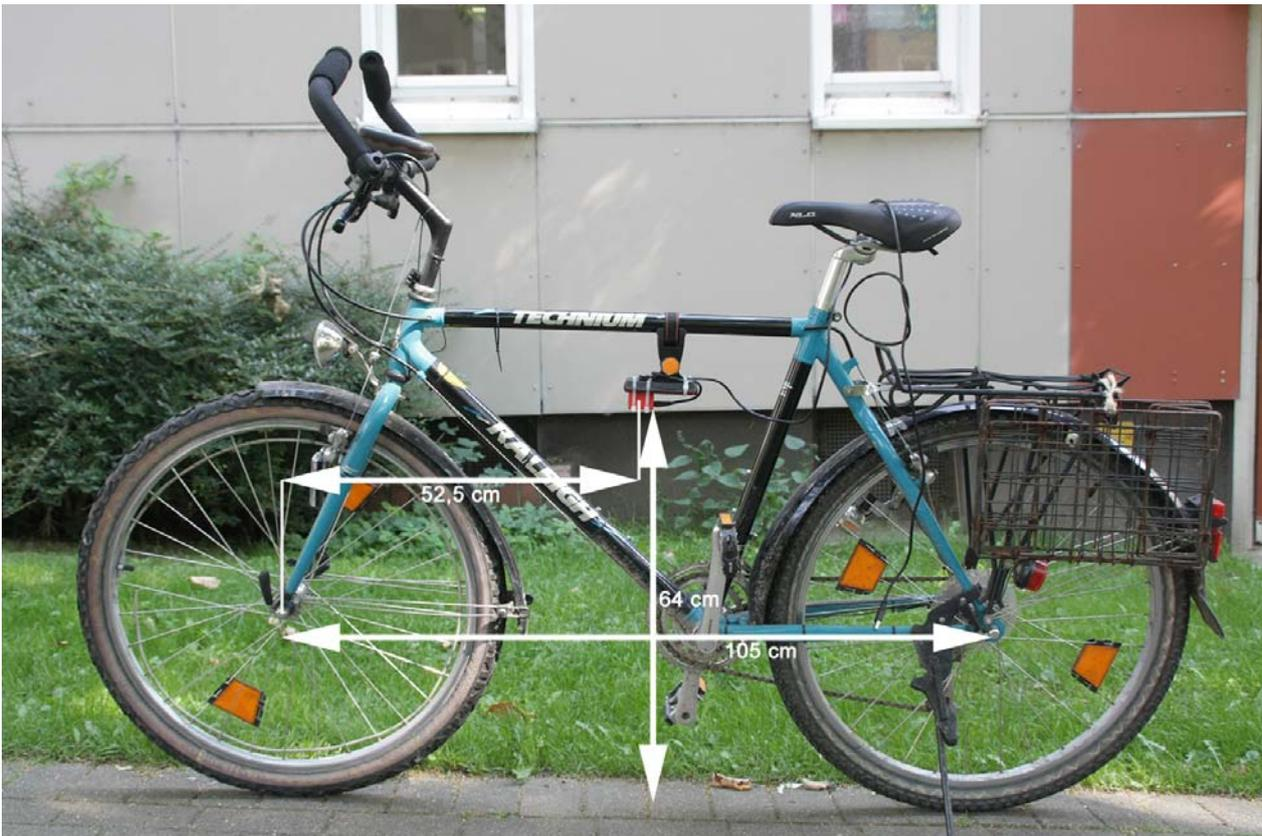
Abb. 10: Messfahrrad mit Montageposition des Beschleunigungssensors.
