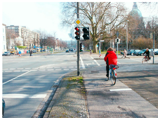
Zeitlicher Vorlauf für Kfz-Rechtsabbieger und Vorlaufgrün für Radverkehr bei gemeinsamer Phase (Hannover)
