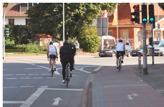
Konfliktfreie Phase mit separater Führung und Regelung für rechtsabbiegende Radfahrende (Münster)
