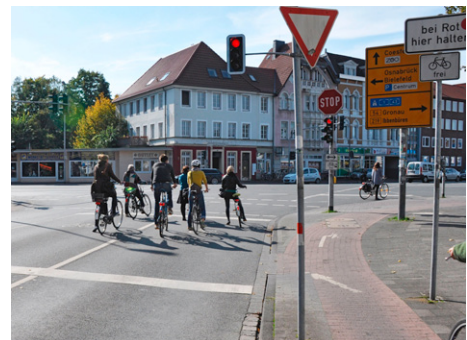
ARAS mit Zufahrt vom Radweg; Hinweiszeichen für Kfz „Bei Rot hier halten“ (Münster)
