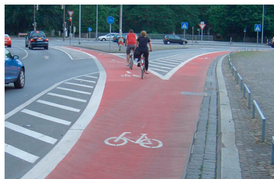
Reduzierung der Abbiegegeschwindigkeiten und Verdeutlichung Konfliktstelle (Hannover)
